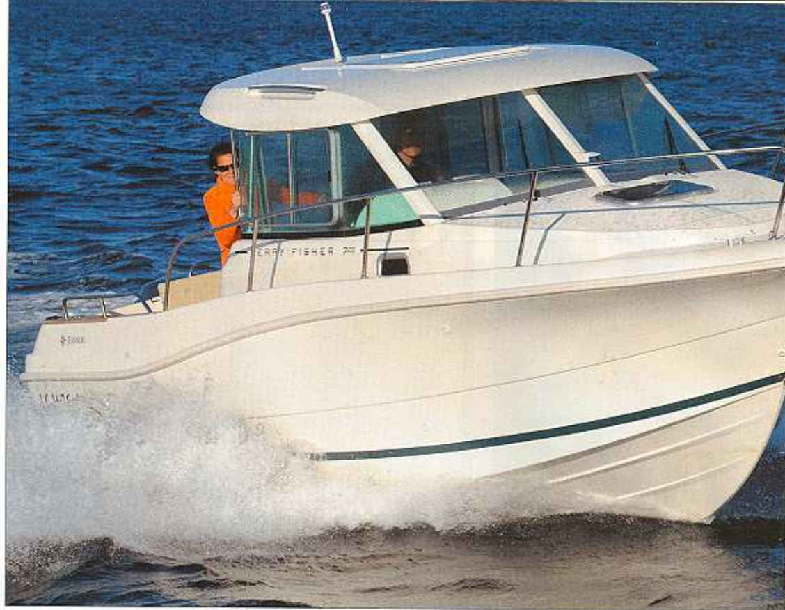
La carène de la 725 HB affiche un V de 15° à l'arrière et de 29° à l'avant. Elle est également plus tulipée et plus planante que celles des anciennes Merry Fisher.
