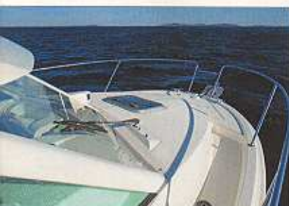
Les passavants ne sont pas à plat-pont, mais creux d'une dizaine de centimètres.
